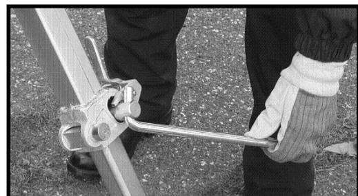
**HINWEIS:** Diese Einstellmöglichkeit darf nicht zum Heben oder Spreizen verwendet werden.
